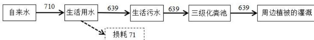
图 1 项目水平衡图 (单位: m<sup>3</sup>/a)
