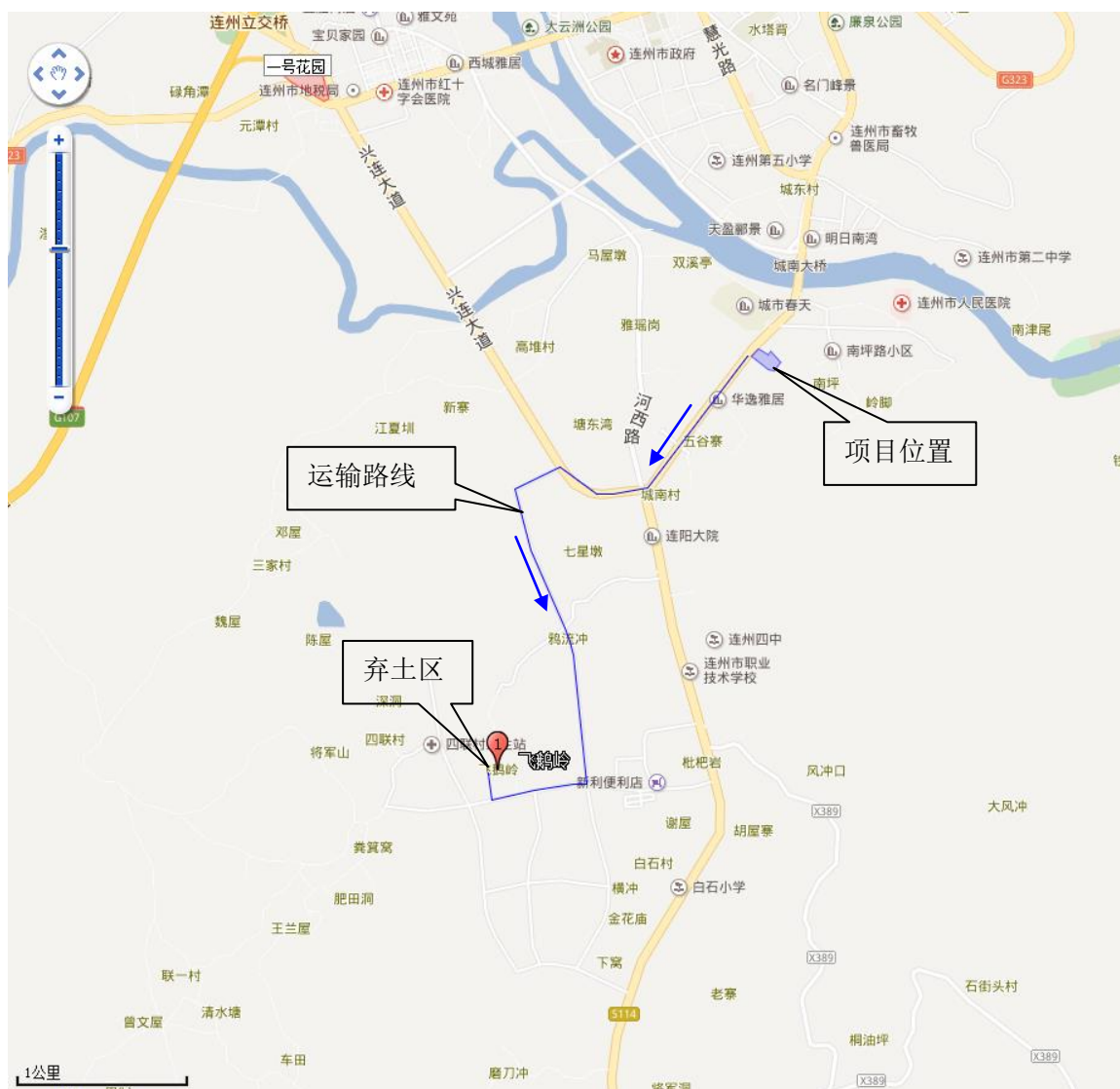
图 2-4 项目土方运输路线图
