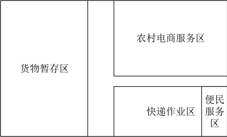
图 4-7 村级物流服务点布局示意图（无农产品、农资需求，不低于 10m 2 ）
